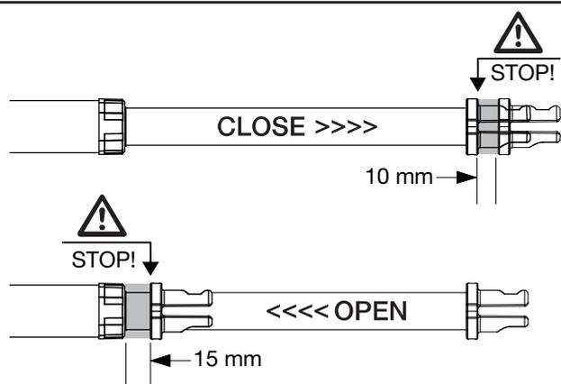
E' obbligatorio lasciare un'extra corsa di 10mm in chiusura e 15mm in apertura per evitare che lo stelo vada in battuta meccanica all'interno del tubo. Rispettare le quote di installazione indicate in Figura 3.
